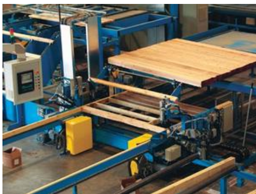
Figur 6 Delar av en starkt automatiserad vägg tillverkning. Vänster: Tillverkning av ram. Höger: Skivan appliceras. En CAD-kontrollerad upplöckning av individuella skivor, positionering och spikning.
