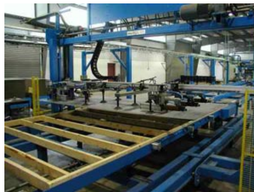
Figur 6 Delar av en starkt automatiserad vägg tillverkning. Vänster: Tillverkning av ram. Höger: Skivan appliceras. En CAD-kontrollerad upplöckning av individuella skivor, positionering och spikning.
